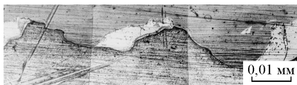
Рис. 9. Микроструктура зоны соединения медно-алюминиевого композита (рис. 5, зона 4).
