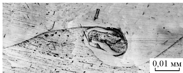
Рис. 8. Микроструктура зоны соединения медно-алюминиевого композита (рис. 5, зона 3).
