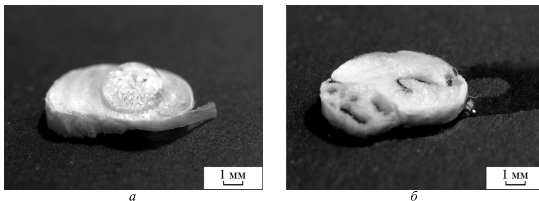
Рис. 5. Капля дистиллированной воды на поверхности необработанного (а) и обработанного ДБР в течение 180 с образца из PLD 04 (б).
