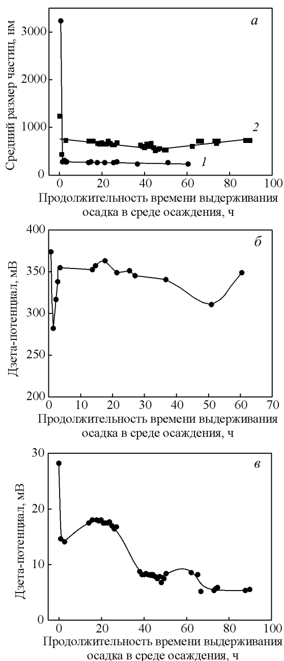
Рис. 2. Изменение размеров частиц осадка в первом (1) и втором (2) экспериментах (а) и \zeta -потенциала системы в первом (б) и во втором (в) экспериментах в процессе старения.
