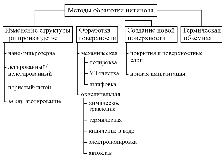
Рис. 1. Классификация методов обработки нитинола, влияющих на коррозионную стойкость.
