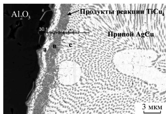
Рис. 2. Микрофотография области спая, полученная на сканирующем электронном микроскопе JSM 6390LV JEOL\*.
