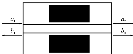
Рис. 2. Схема размещения образца композиционного материала в адаптере Р4-53. Направление распространения падающих ( a_1 и a_2 ) и отраженных ( b_1 и b_2 ) электромагнитных волн.
