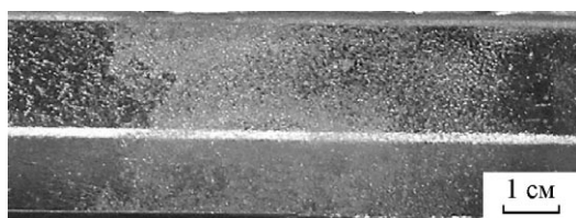
Рис. 3 Фотография зоны anomalously высокой повреждаемости внутренней поверхности облученной трубы состава 25Cr12Mn20W после 4 импульсов воздействия потоков ионов дейтерия и ДП в установке ПФ-1000. “Холодный” конец трубы — справа (оптическая микроскопия).
