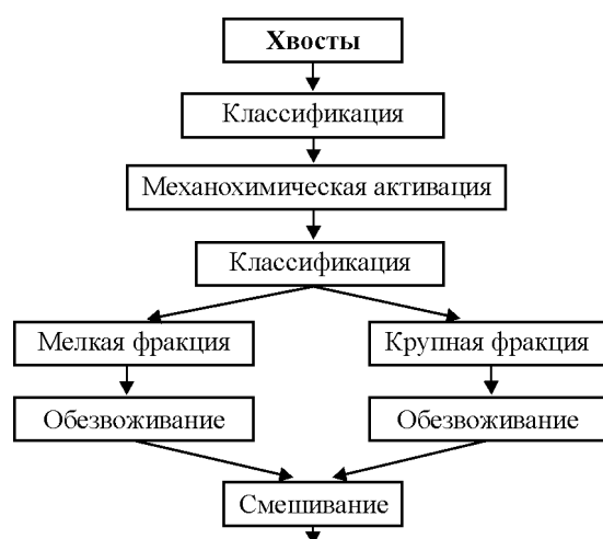
Рис. 3. Схема приготовления твердеющей смеси на основе хвостов обогащения.
